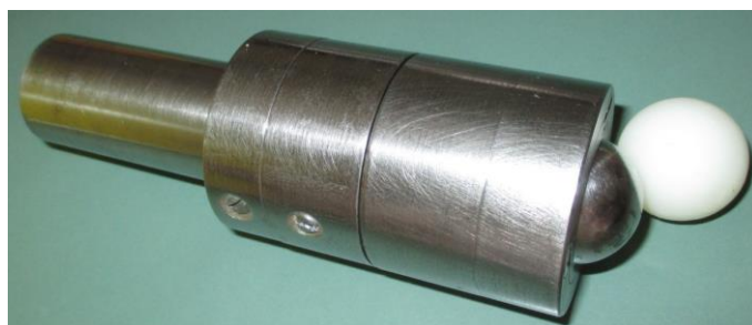
Slika 5- Čelična masa (teg) sa udarnim glavama
