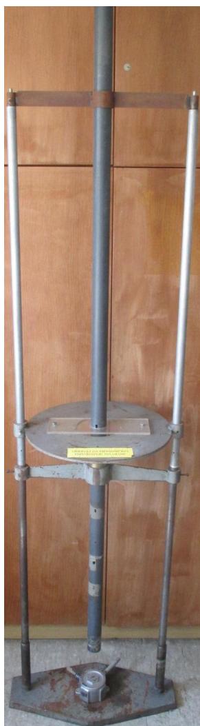
Slika 4- Fotografija uređaja za mehaničko ispitivanje na udar slobodnim padom
